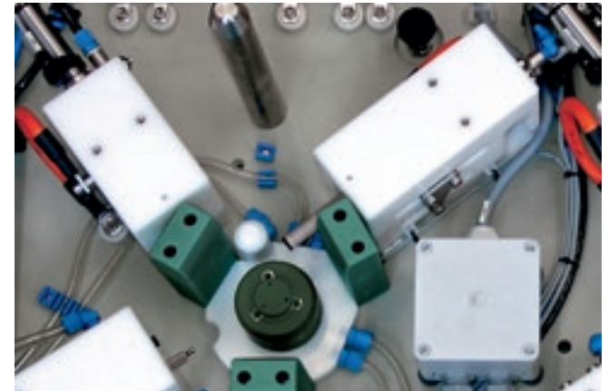
Selektive Bearbeitung eines Werkstückes zur Erzeugung unterschiedlicher Kantenbrüche
