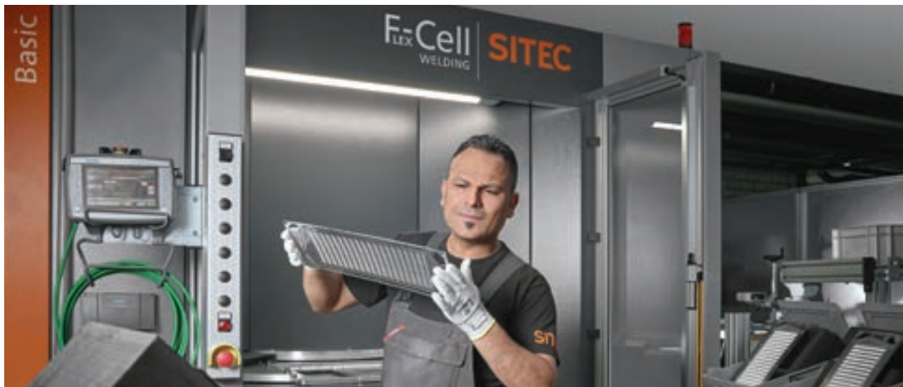
Bipolar-Plattengrößen bis zu 600 x 300 mm, Blechdicke \geq 0,07 bis 0,5 mm, Ausführung mit oder ohne Beschichtung Bipolar plate sizes up to 600 x 300 mm, Plate thickness \geq 0,07 to 0,5mm, version with or without coating
